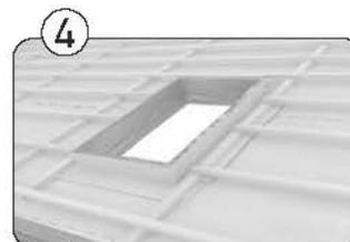
Нахлёсты, повреждения или отверстия должны быть обработаны, используя соответствующую клеящую ленту. Для примыкания к элементам кровли нужно использовать кровельный герметик или бутиловую ленту.
