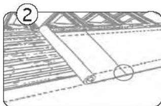
При укладке Ковельной пароизоляционной плёнки нужно использовать 15 см нахлёста. Нахлёсты фиксируются двусторонней клеящей лентой. Дополнительно, вдоль линии нахлёста можно использовать ремонтную ленту, тем самым обеспечивая улучшенную герметичность.
